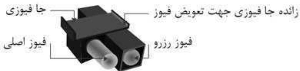
بدین منظور می بایست ابتدا کابل برق دستگاه را از پشت دستگاه خارج شود. سپس با استفاده از یک پیچ گوشتی تخت، به زائده جافیوزی به سمت بیرون نیرو وارد کرده و آن را خارج نمایید. در شکل زیر نمایی از محل قرارگیری فیوز اصلی و رزرو نشان داده شده است. یک فیوز رزرو (اضافی) نیز در محفظه مربعی شکل قرار داده شده است و در صورت نیاز می توان آن را جایگزین نمود.
